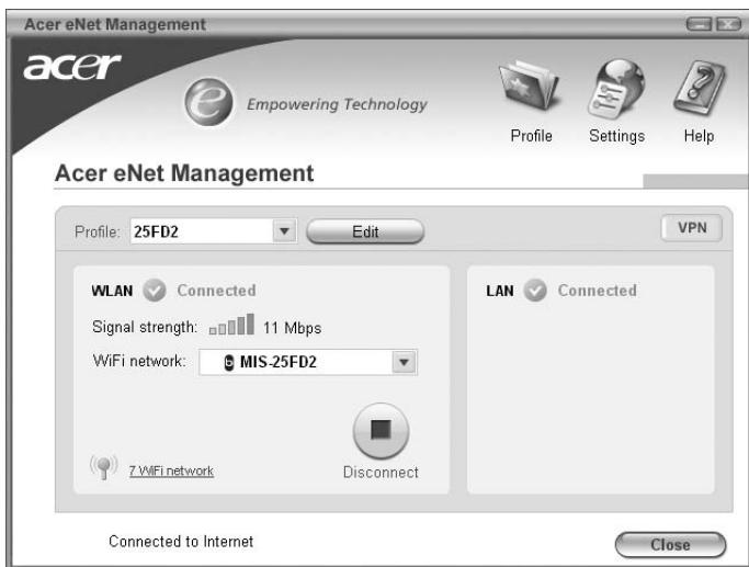
Утилита Acer eNet Management позволяет сохранять сетевые настройки для разных мест в соответствующих профилях и автоматически применяет их, когда пользователь передвигается из одного места в другое. Сохраняются такие настройки, как параметры подключения к сети (IP-адреса и параметры сервера DNS, сведения о беспроводной точке доступа и т.д.), а также стандартные настройки принтера. Из соображений безопасности утилиты Acer eNet Management не сохраняет имя пользователя и его пароль.
