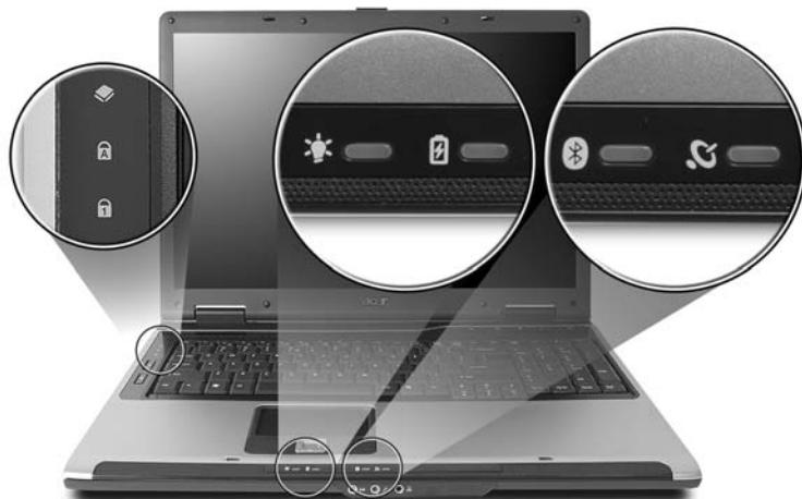
Индикаторы на передней панели видны даже при закрытой крышке компьютера.
