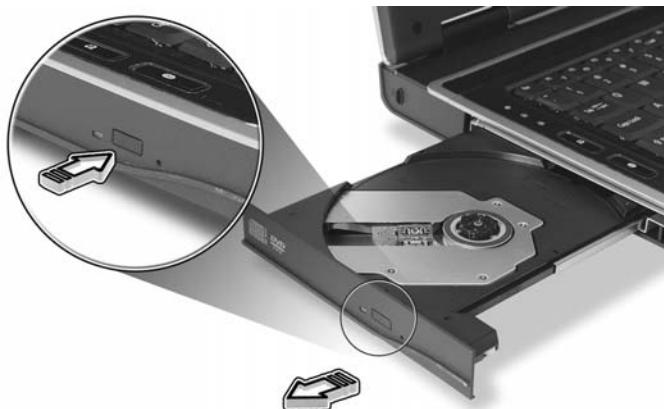
Чтобы открыть привод оптических дисков, когда компьютер выключен, вставьте скрепку в отверстие аварийного извлечения.
