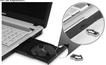
Con el ordenador apagado, puede expulsar la bandeja de la unidad mediante el orificio de expulsión de emergencia.
