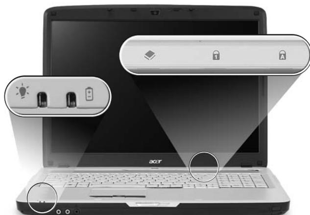
Les indicateurs du panneau avant sont visibles même lorsque l'écran LCD est fermé.
