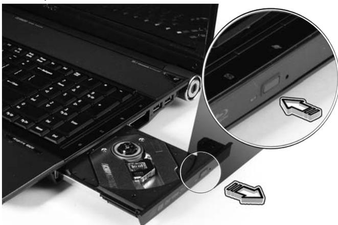
Quando è spento, è possibile espellere il vassoio del drive utilizzando il foro di apertura di emergenza.
