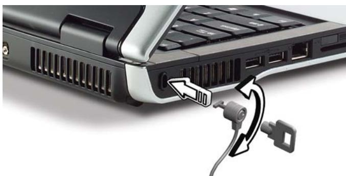
Pripojte kábel bezpečnostného zámku počítača k nepohyblivému predmetu, napríklad stolu alebo držadlu zaistenej zásuvky. Vložte zámok do otvoru a otočte klúčom kvôli zaisteniu zámku. Niektoré modely sú dostupné aj bez zámku.
