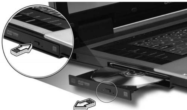
Com a alimentação desligada, é possível ejectar o tabuleiro da unidade utilizando o furo de ejeção de emergência.
