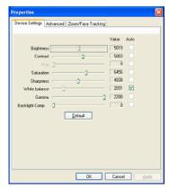
**Device Settings** permite alterar a luminosidade, contraste, tonalidade, saturação, nitidez, etc.
