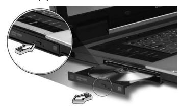
Com a alimentação desligada, é possível ejectar o tabuleiro da unidade utilizando o furo de ejecção de emergência.
