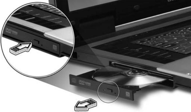
Con el ordenador apagado, puede expulsar la bandeja de la unidad mediante el orificio de expulsión de emergencia.
