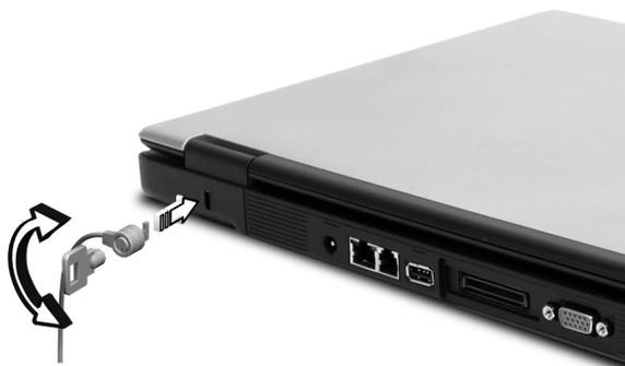
Enroulez le câble du cadenas de sécurité pour ordinateur autour d'une table, de la poignée d'un tiroir verrouillé, ou de tout autre objet fixe. Insérez le cadenas dans l'encoche et tournez la clef pour verrouiller le cadenas. Certains modèles ne possèdent pas d'encoche.
