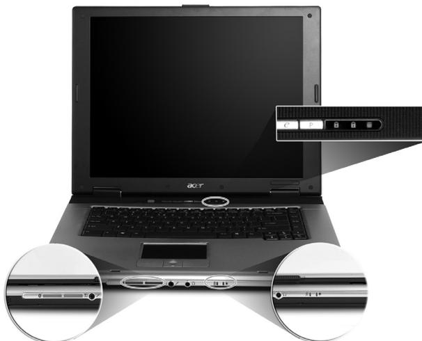
Les indicateurs d'état Alimentation, Batterie et Communication sans fil sont visibles même lorsque l'écran LCD est fermé.
