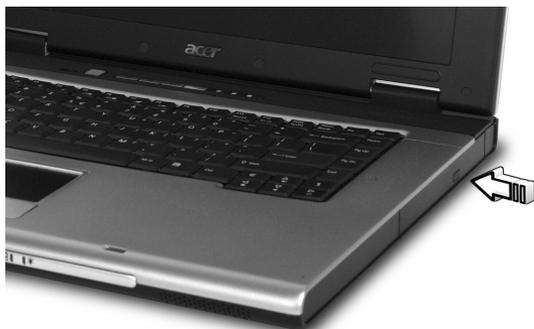
Quando è spento, è possibile espellere il vassoio del drive utilizzando il foro di apertura di emergenza.
