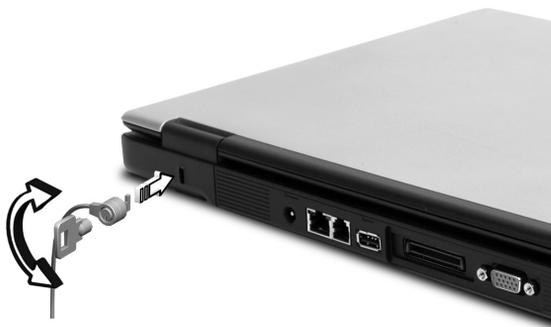
Avvolgere un cavo di sicurezza per computer intorno ad un oggetto fisso, ad esempio un tavolo o la maniglia di un cassetto chiuso a chiave. Inserire la serratura nel foro e girare la chiave per fissare il blocco. Sono disponibili anche modelli senza chiave.
