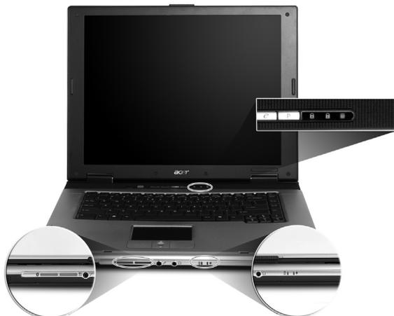
Gli indicatori di alimentazione, batteria e collegamento wireless sono visibili anche quando il display LCD è chiuso.
