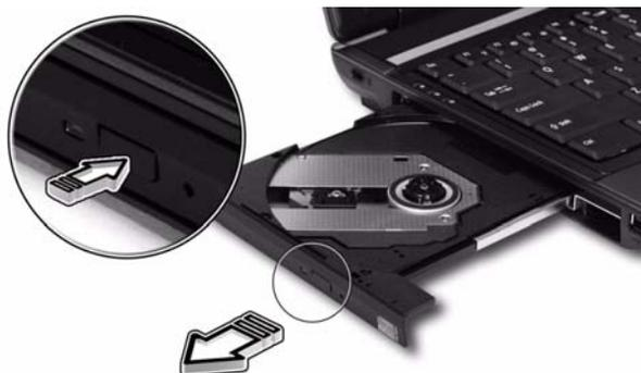
Quando è spento, è possibile espellere il vassoio del drive utilizzando il foro di apertura di emergenza.
