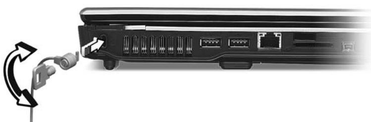
Pripojte kábel bezpečnostného zámku počítača k nepohyblivému predmetu, napríklad stolu alebo držadlu zaistenej zásuvky. Vložte zámok do otvoru a otočte kľúčom kvôli zaisteniu zámku. Niektoré modely sú dostupné aj bez zámku.
