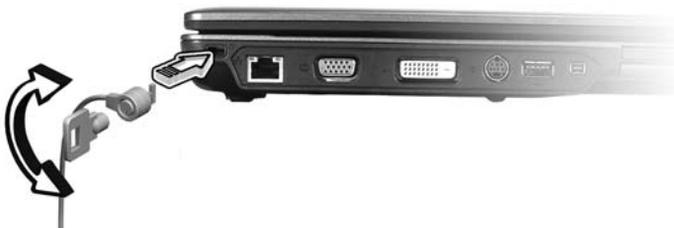
Binden Sie ein Diebstahlsicherungskabel an ein unbewegliches Objekt wie einen Tisch oder einen Griff einer abgeschlossenen Schublade. Stecken Sie das Schloss in den Anschluss für die Diebstahlsicherung, und schließen Sie dieses ab. Es gibt auch Modelle ohne Schlüssel.
