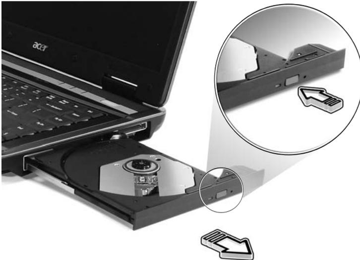
Wenn der Computer ausgeschaltet ist, können Sie den Laufwerksträger mit Hilfe des mechanischen Auswurflochs herausfahren.
