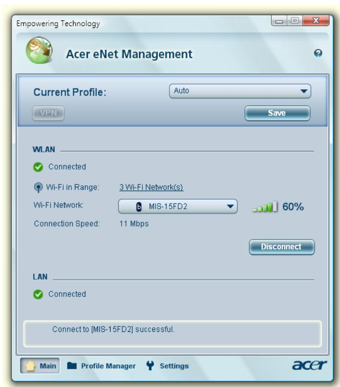
Acer eNet Management puede guardar la configuración de red para una ubicación en un perfil y aplicar automáticamente el perfil apropiado cuando cambie de una ubicación a otra. La configuración almacenada incluye la configuración de conexión a la red (parámetros IP y DNS, información de AP inalámbrico, etc.), así como la configuración de impresora predeterminada.
