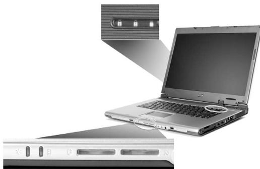
Los indicadores de estado de encendido/apagado batería y comunicación inalámbrica son visibles, aunque se cierre la pantalla LCD.
