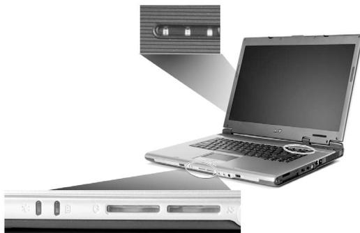
Les indicateurs d'état de l'alimentation, de la batterie et de la communication sans fil sont visibles même lorsque l'écran LCD est fermé.
