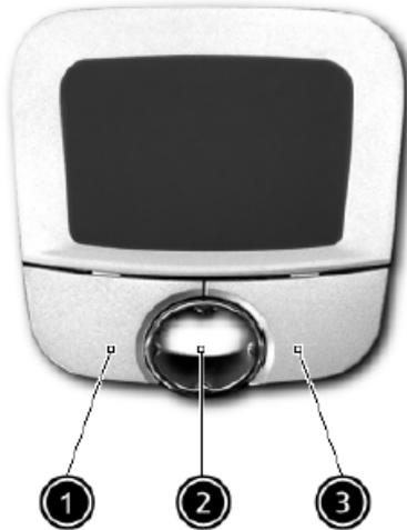
**! Внимание !** Если Вы используете внешнее указательное устройство, то внутреннюю сенсорную панель можно отключить нажатием клавиши Fn-F7. Если Вы хотите использовать внешнее указательное устройство с интерфейсом PS/2 то сначала необходимо подсоединить внешнее устройство, а затем, если это необходимо, отключить сенсорную панель.
