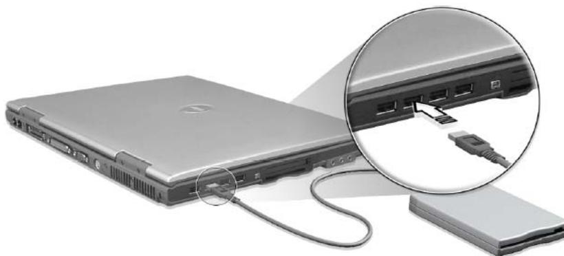
Для подключения и отключения USB устройств Вам не требуется выключать компьютер. Вы можете подключить в один порт несколько USB устройств с помощью концентратора USB.
