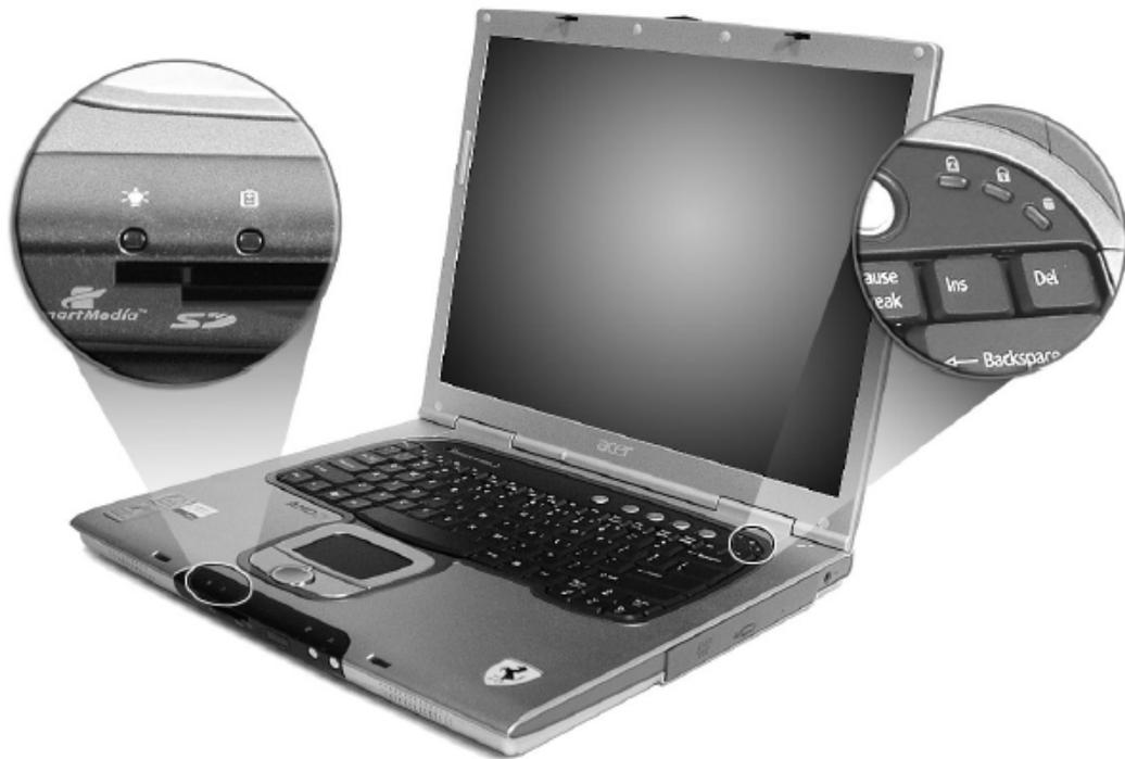
Индикаторы питания ноутбука и состояния батареи видны как при открытой, так и при закрытой крышке дисплея.
