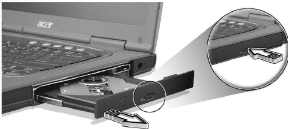
Чтобы поместить оптический диск в дисковод, поместите CD или DVD диск в лоток до щелчка, а затем закройте лоток.
