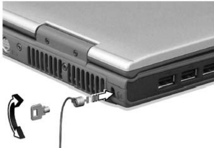
Обмотайте трос защитного замка вокруг неподвижного предмета (например, ножки стола или ручки запертого ящика стола). Вставьте замок в разъем на ноутбуке и поверните ключ, чтобы запереть замок.
