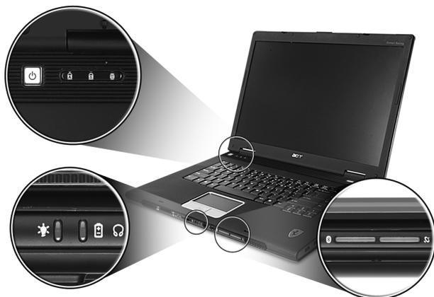
Les indicateurs d'état Alimentation, Batterie et Communication sans fil sont visibles même lorsque l'écran LCD est fermé.
