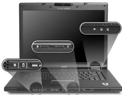
Les indicateurs du panneau avant sont visibles même lorsque l'écran LCD est fermé.
