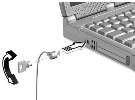
Enroulez le câble du cadenas de sécurité pour ordinateur autour d'une table, de la poignée d'un tiroir verrouillé, ou de tout autre objet fixe. Insérez le cadenas dans l'encoche et tournez la clef pour verrouiller le cadenas.
