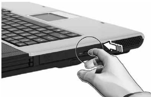
Wenn der Computer ausgeschaltet ist, können Sie den Laufwerksträger über den Notauswurf ausfahren. Siehe Seite 48.
