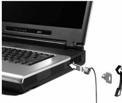
Binden Sie ein Diebstahlsicherungskabel an ein unbewegliches Objekt wie einen Tisch oder einen Griff einer abgeschlossenen Schublade. Stecken Sie das Schloß in den Anschluß für die Diebstahlsicherung, und schließen Sie dieses ab. Es gibt auch Modelle ohne Schloß.
