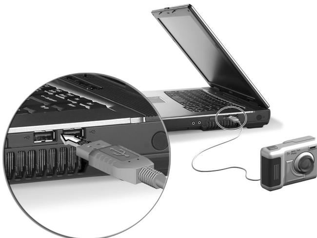
O padrão USB é Plug-and-Play, o que significa que é possível ligar e começar a utilizar um dispositivo USB sem ter que reiniciar o computador. Pode-se também desligar o dispositivo a qualquer instante.
