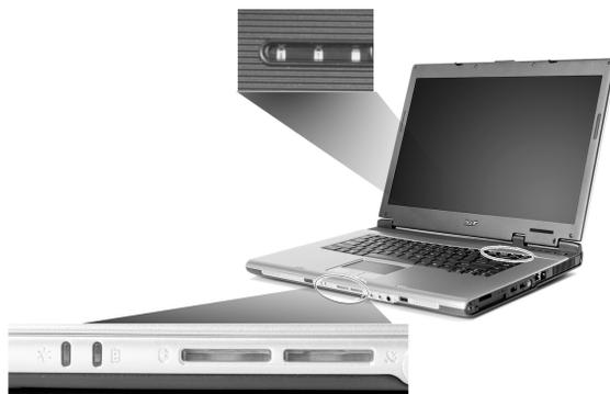
Os indicadores de estado Liga-desliga, Bateria e Comunicação sem fios podem ser vistos mesmo com o ecrã de cristal líquido fechado.
