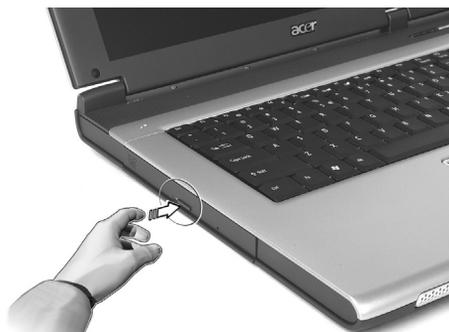
Com a energia desligada, pode-se ejectar o tabuleiro da unidade utilizando o furo de ejecção de emergência.
