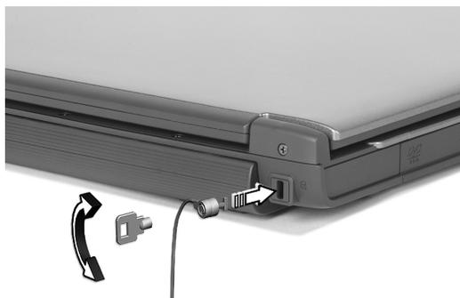
Enrole um cabo de bloqueio de segurança do computador em torno de um objecto imóvel, como por exemplo uma mesa ou o puxador de uma gaveta fechada. Introduza o bloqueio na ranhura da chave de protecção de segurança e rode a chave para proteger o bloqueio. Também estão disponíveis modelos sem chave.
