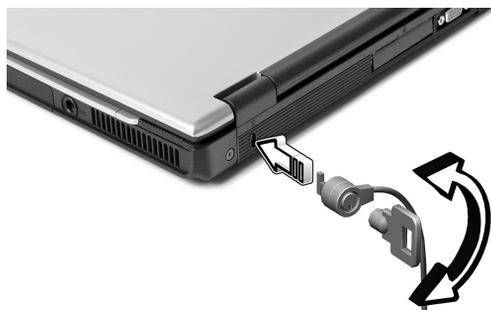
Enroulez le câble du cadenas de sécurité pour ordinateur autour d'une table, de la poignée d'un tiroir verrouillé, ou de tout autre objet fixe. Insérez le cadenas dans l'encoche et tournez la clé pour verrouiller le cadenas. Certains modèles ne possèdent pas d'encoche.
