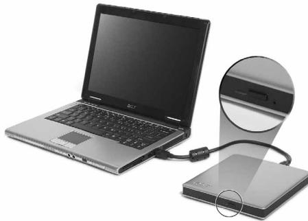
Wenn der Computer ausgeschaltet ist, können Sie den Laufwerksträger über das Notauswurfloch ausfahren.
