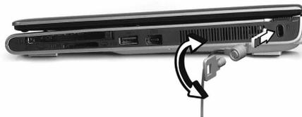
Binden Sie ein Diebstahlsicherungskabel an ein unbewegliches Objekt wie einen Tisch oder einen Griff einer abgeschlossenen Schublade. Stecken Sie das Schloß in den Anschluß für die Diebstahlsicherung, und schließen Sie dieses ab. Es gibt auch Modelle auch Schloß.
