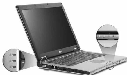
Los indicadores de estado de encendido/apagado, Batería y Comunicación inalámbrica pueden ser vistos con la pantalla LCD cerrada.
