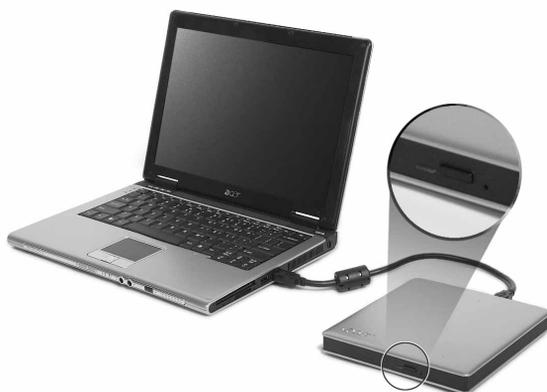
Pero si tiene la computadora apagado deberá usar la ranura de expulsión de emergencia.
