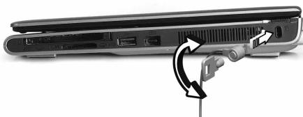
Обмотайте кабелем замка безопасности для компьютеров неподвижный предмет, например, стол или ручку запертого ящика. Вставьте замок в выемку и поверните ключ, чтобы запереть замок. Бывают и модели замков без ключей.
