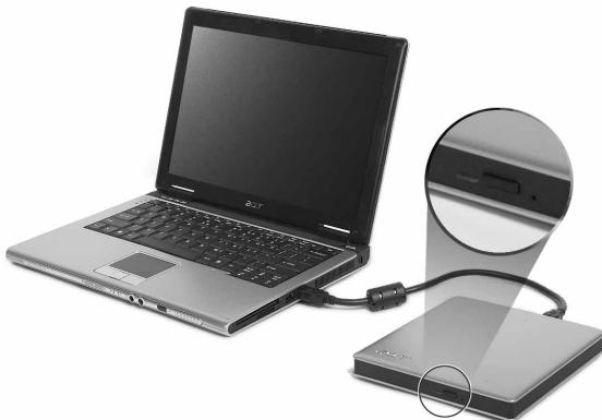
При отключенном питании вы можете вытащить лоток дисковода с помощью отверстия выброса при аварийных случаях.
