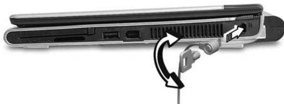
Enroulez le câble du cadenas de sécurité pour ordinateur autour d'une table, de la poignée d'un tiroir verrouillé, ou de tout autre objet fixe. Insérez le cadenas dans l'encoche et tournez la clef pour verrouiller le cadenas. Certains modèles ne possèdent pas de clef.
