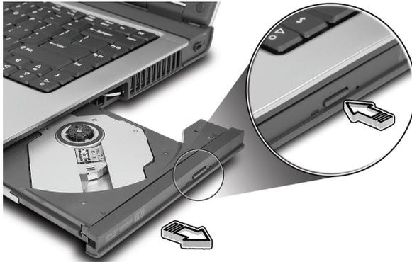
Wenn der Computer ausgeschaltet ist, können Sie den Laufwerksträger über das Notauswurfloch ausfahren.
