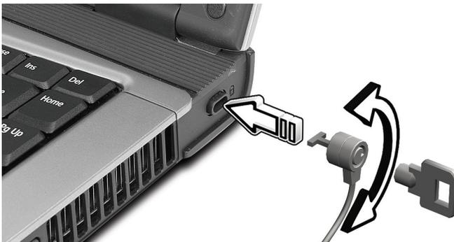
Binden Sie ein Diebstahlsicherungskabel an ein unbewegliches Objekt wie einen Tisch oder einen Griff einer abgeschlossenen Schublade. Stecken Sie das Schloß in den Anschluß für die Diebstahlsicherung, und schließen Sie dieses ab. Es gibt auch Modelle auch Schloß.
