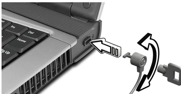
Enroulez le câble du cadenas de sécurité pour ordinateur autour d'une table, de la poignée d'un tiroir verrouillé, ou de tout autre objet fixe. Insérez le cadenas dans l'encoche et tournez la clef pour verrouiller le cadenas. Certains modèles ne possèdent pas d'encoche.
