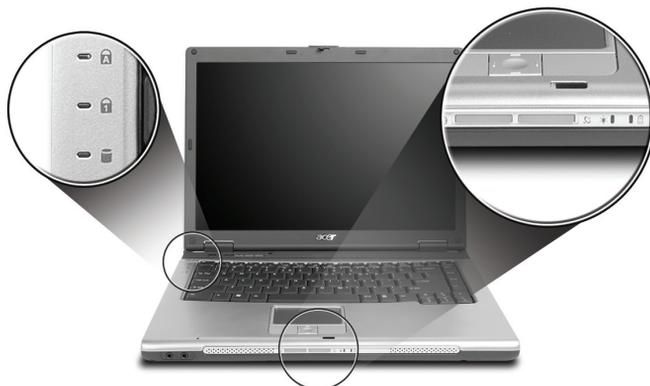
Les indicateurs d'état Alimentation, Batterie et Communication sans fil sont visibles même lorsque l'écran LCD est fermé.
