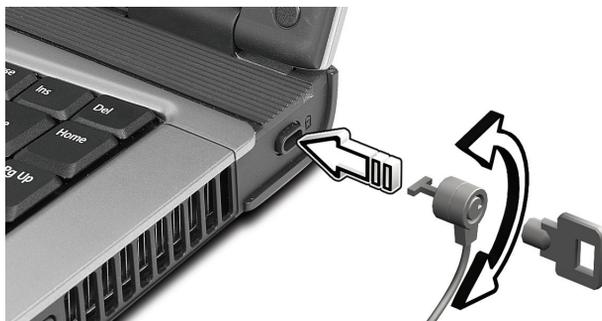
Обмотайте кабелем замка безопасности для компьютеров неподвижный предмет, например, стол или ручку запортого ящика. Вставьте замок в выемку и поверните ключ, чтобы запереть замок. Бывают и модели замков без ключей.
