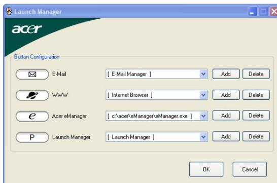
Программа Launch Manager позволяет задавать действия для четырех кнопок быстрого запуска, расположенных над клавиатурой. См. **“Кнопки быстрого запуска”** на стр. 12, где показано расположение кнопок быстрого запуска.
