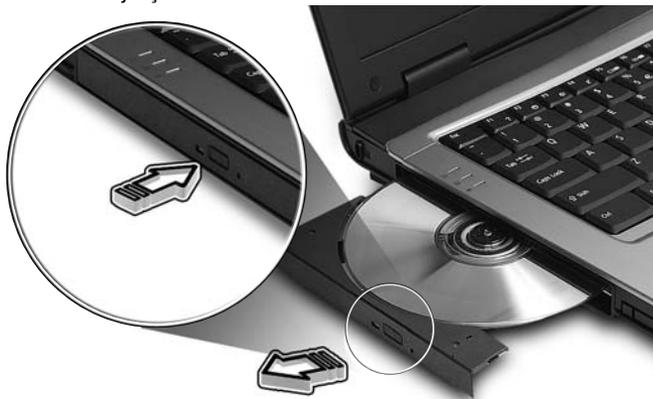
Introduza um clipe no orifício de ejeção de emergência para ejectar o tabuleiro da unidade óptica quando o computador está desligado.
