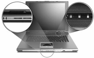
Индикаторы состояния "Питание", "Аккумулятор" и "Беспроводная связь" видны даже при закрытой крышке ЖК-дисплея.
