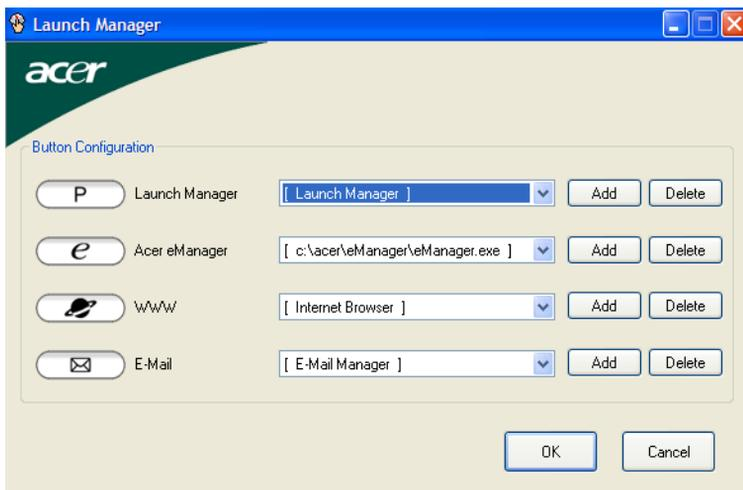
Launch Manager permite definir los 4 botones de lanzamiento fácil situados en la parte superior del teclado. Vea la sección "**Botones de lanzamiento fácil**" en la **página 10** para determinar su ubicación.
