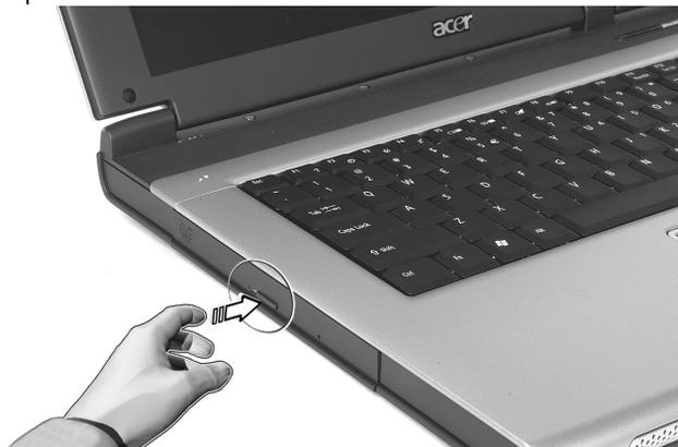
Con el ordenador apagado, puede expulsar la bandeja de la unidad mediante el orificio de expulsión de emergencia.
