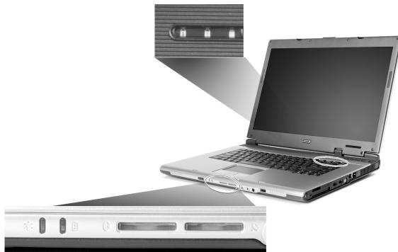
Индикаторы состояния "Питание", "Аккумулятор" и "Беспроводная связь" видны даже при закрытой крышки ЖК-дисплея.
