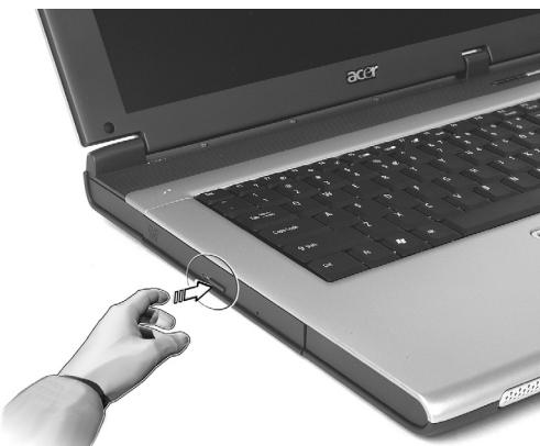
При отключенном питании лоток привода можно открыть, вставив тонкий стержень в отверстие аварийного извлечения.
