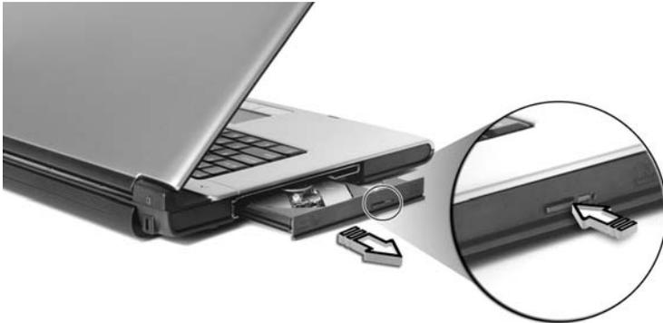
Wenn der Computer ausgeschaltet ist, können Sie den Laufwerksträger über das Notauswurfloch ausfahren.
