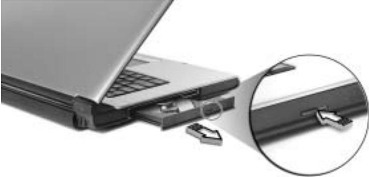
Pero si tiene la computadora apagado deberá usar la ranura de expulsión de emergencia.
