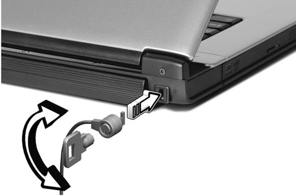
Enrole um cabo de bloqueio de segurança do computador em torno de um objecto imóvel, como por exemplo uma mesa ou o puxador de uma gaveta fechada. Introduza o bloqueio na ranhura da chave de protecção de segurança e rode a chave para proteger o bloqueio. Também estão disponíveis modelos sem chave.
