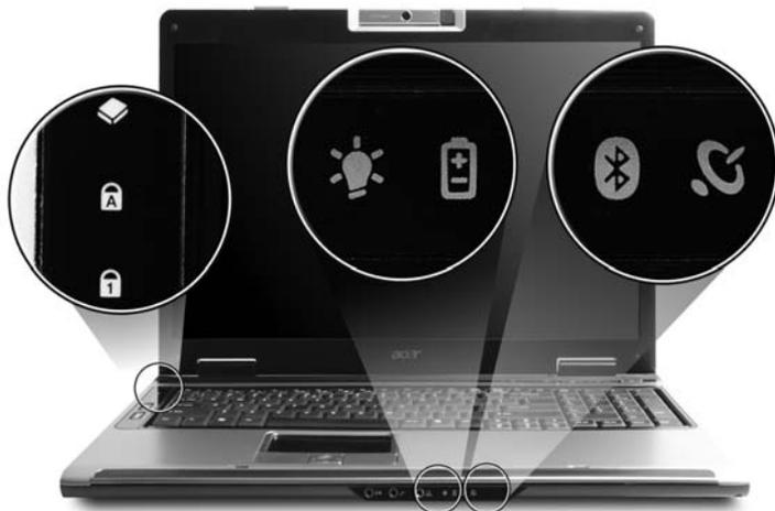
Индикаторы на передней панели видны даже при закрытой крышке компьютера.
