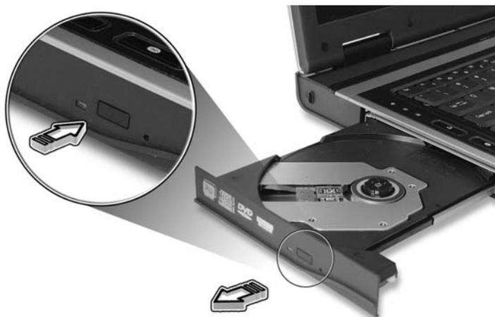
Con el ordenador apagado, puede expulsar la bandeja de la unidad mediante el orificio de expulsión de emergencia.
