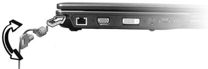
Avvolgere un cavo di sicurezza per computer intorno ad un oggetto fisso, ad esempio un tavolo o la maniglia di un cassetto chiuso a chiave. Inserire la serratura nel foro e girare la chiave per fissare il blocco. Sono disponibili anche modelli senza chiave.
