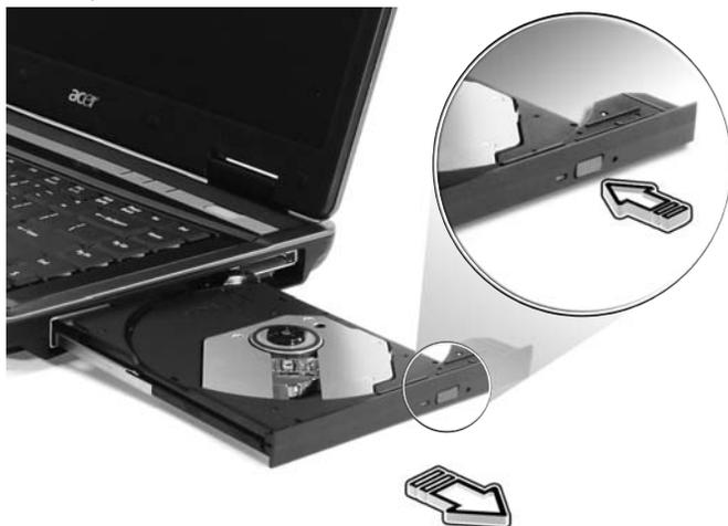
Quando è spento, è possibile espellere il vassoio del drive utilizzando il foro di apertura di emergenza.
