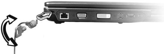
Обмотайте кабелем замка безопасности для компьютеров неподвижный предмет, например, стол или ручку запертого ящика. Вставьте замок в выемку и поверните ключ, чтобы запереть замок. Бывают и модели замков без ключей.
