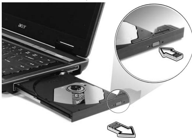
При отключенном питании лоток привода можно открыть, вставив тонкий стержень в отверстие аварийного извлечения.
