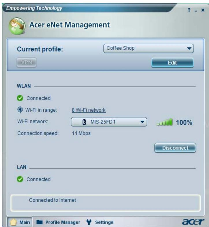
Acer eNet Management kann Netzwerkeinstellungen für einen Ort in einem Profil speichern und automatisch das gewünschte Profil einstellen, wenn Sie von einem Ort zu einem anderen gehen. Zu den gespeicherten Einstellungen gehören Einstellungen für die Netzwerkverbindung (IP- und DNS-Einstellungen, Wireless-AP-Details usw.), sowie standardmäßige Druckereinstellungen. Aufgrund von Sicherheitsfragen speichert Acer eNet Management nicht Informationen wie Benutzername und Kennwort.
