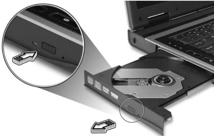
Wenn der Computer ausgeschaltet ist, können Sie den Laufwerksträger mit Hilfe des mechanischen Auswurflochs herausfahren.
