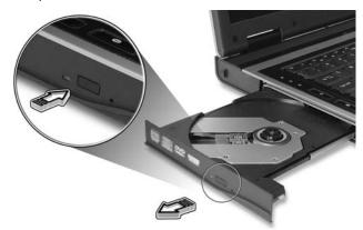
Quando è spento, è possibile espellere il vassoio del drive utilizzando il foro di apertura di emergenza.
