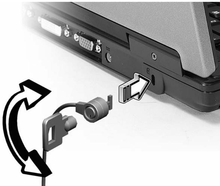
Enroulez le câble du cadenas de sécurité pour ordinateur autour d'une table, de la poignée d'un tiroir verrouillé, ou de tout autre objet fixe. Insérez le cadenas dans l'encoche et tournez la clef pour verrouiller le cadenas. Certains modèles ne possèdent pas de clef.
