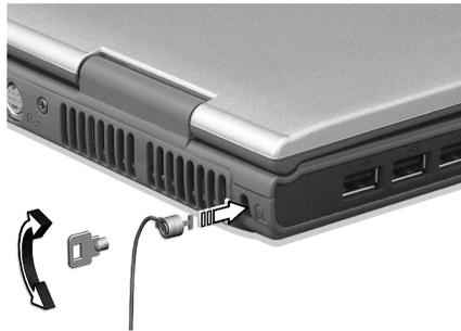
Enrole um cabo de bloqueio de segurança do computador em torno de um objecto imóvel, como por exemplo uma mesa ou o puxador de uma gaveta fechada. Introduza o bloqueio na ranhura da chave de protecção de segurança e rode a chave para proteger o bloqueio. Também estão disponíveis modelos sem chave.
