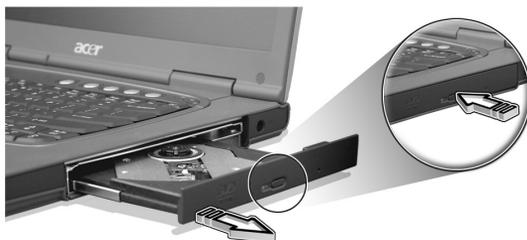
Quando a corrente está desligada, pode ejectar o tabuleiro da unidade utilizando o orifício de ejeção de emergência. Consultar página 61.
