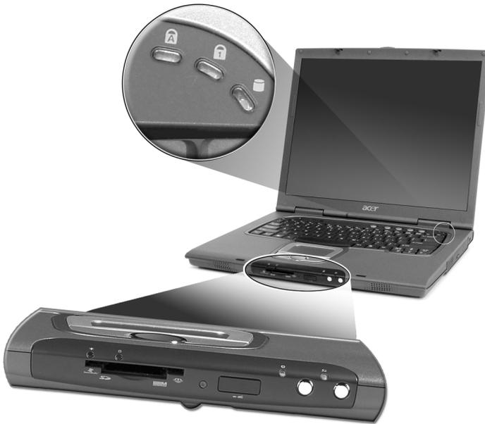
Die Batterie- und Stromversorgung-Status Anzeigen sind zu sehen, wenn Sie die Anzeige schließen.
