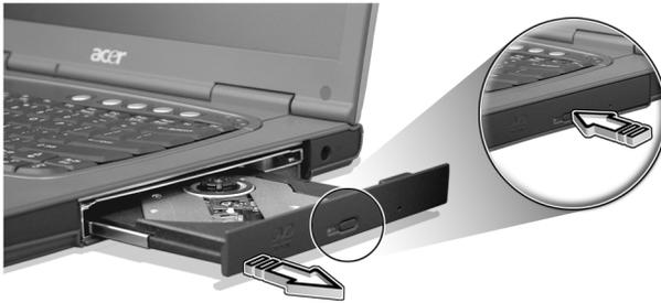
Wenn der Computer ausgeschaltet ist, können Sie den Laufwerksträger über das Notauswurfloch ausfahren. Siehe Seite 67.
