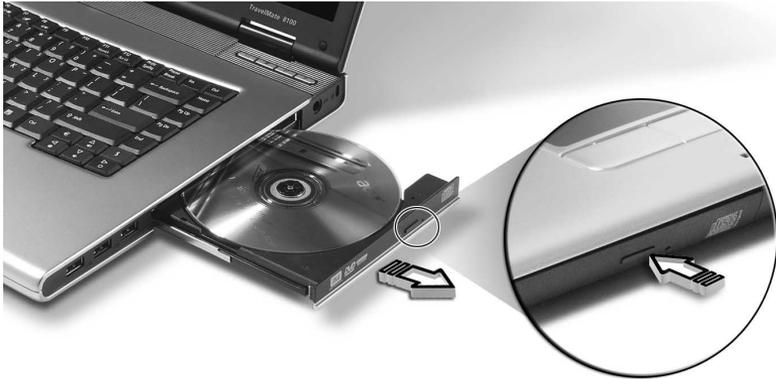
Pero si tiene la computadora apagado deberá usar la ranura de expulsión de emergencia.
