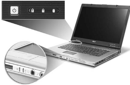
Los indicadores de estado de encendido/apagado, Batería y Comunicación inalámbrica pueden ser vistos con la pantalla LCD cerrada.
