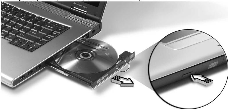
При отключенном питании вы можете вытащить лоток дисковода с помощью отверстия выброса при аварийных случаях.
