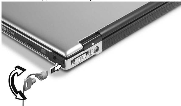
Обмотайте кабелем замка безопасности для компьютеров неподвижный предмет, например, стол или ручку запертого ящика. Вставьте замок в выемку и поверните ключ, чтобы запереть замок. Бывают и модели замков без ключей.
