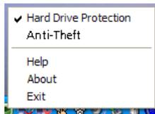
Al seleccionar esta función, se aparcarán los cabezales del disco duro si se detecta cualquier tipo de vibración o movimiento de nivel superior al nivel tolerado por el disco duro.
