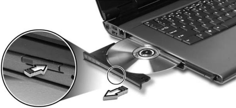
Introduzca un clip en el orificio de expulsión para expulsar la bandeja de la unidad óptica cuando el ordenador esté apagado.
